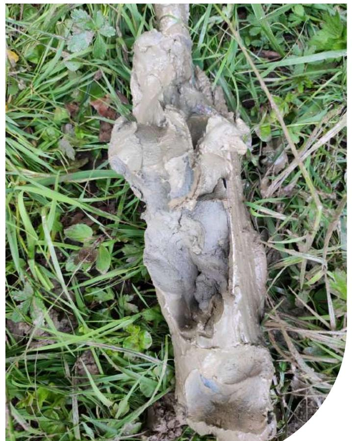
Test à la tarière : à gauche mélange d'argile et de limon et à droite, de l'argile pure
